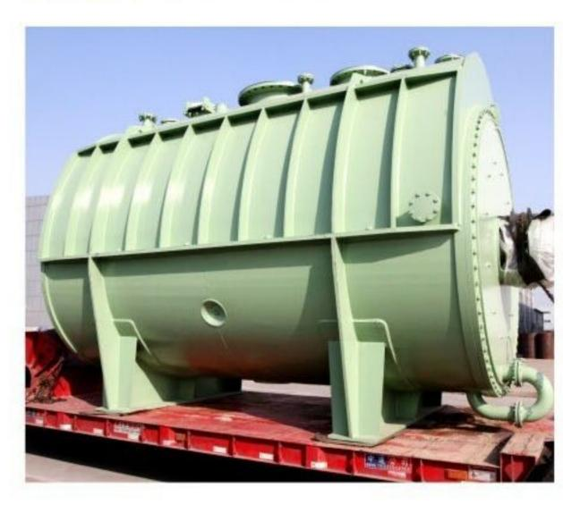
黄化机是粘胶短纤生产的核心设备,其作用是将碱纤维 素与二硫化碳发生反应,生成纤维素黄酸酯,并溶解于碱液 中,初步形成粘胶溶液。
