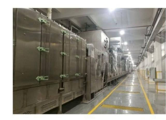
烘干联合机包括湿开棉机、喂给机、烘干机、精开棉机组 成,其作用是对精炼后的湿纤维进行烘干,去除多余的水分, 达到成品纤维回潮率,并对纤维进一步进行开松,提高纤维的
